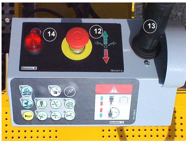
Foto 5 : Posto de comando plataforma
