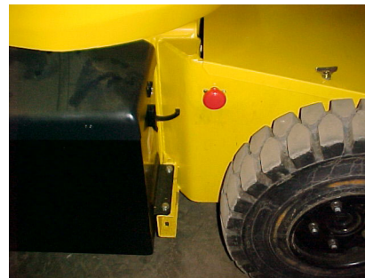
Foto 4 : Botão de corte da bateria
