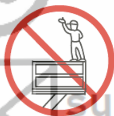
Risco de queda
